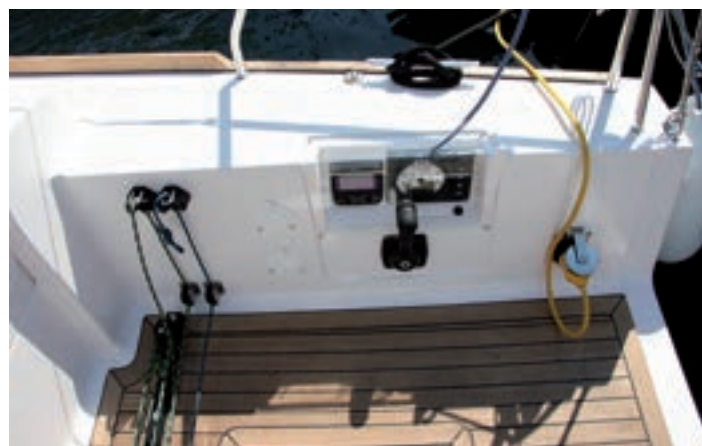
En la banda se sitúan las mordazas del carro de mayor y backstay y los mandos del motor.
