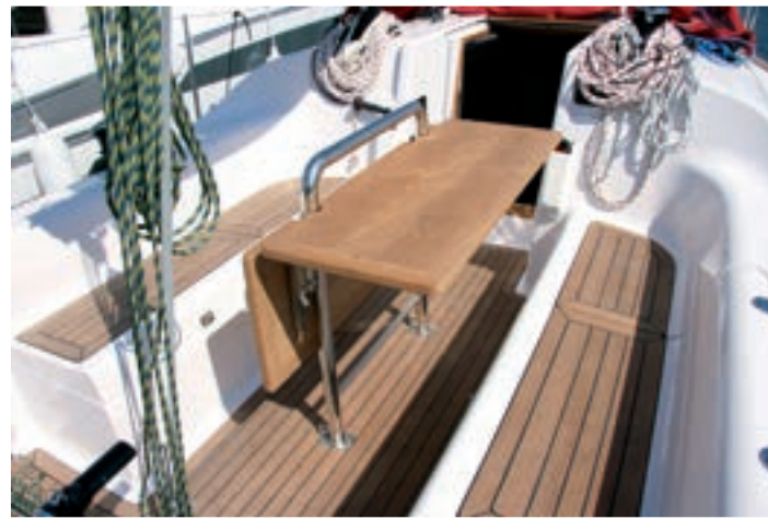
La mesa, de estructura tubular, es desmontable y cuenta con alas plegables, perfecto para el crucero.
