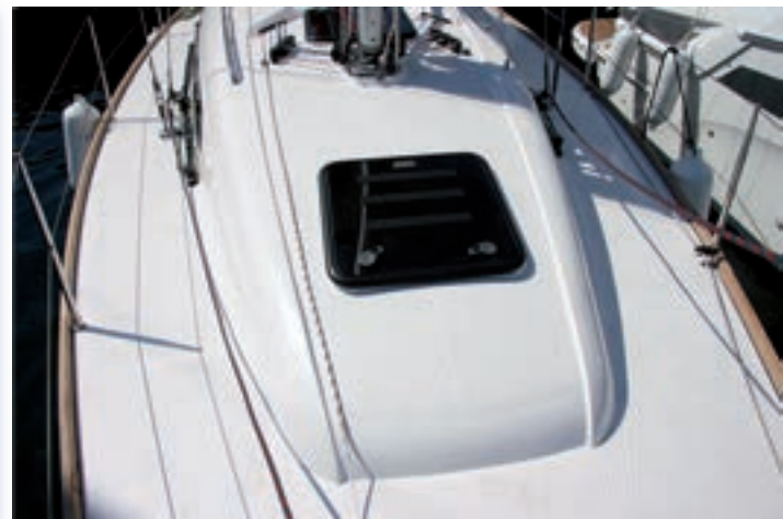
En la cubierta de proa incluye una escotilla de buen tamaño para pasar velas.
