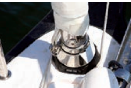
El tambor enrollable bajo cubierta.
