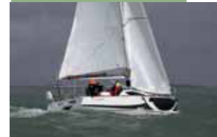
Lft 8,88 m; Beam 3,45 m; Dspl 2,8 t; pescaggio 0,95-2,25 m
